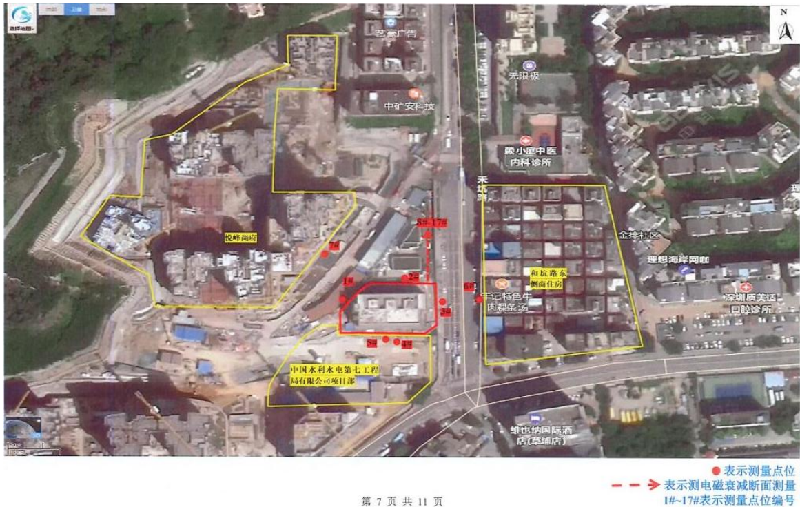
图 1 110kV 木棉岭变电站类比监测布点图
